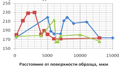
Рис. 5. Изменение микротвердости в сечениях 1 – 1, 2 – 2 образца № 54: ряд 1 – сечение 1 – 1, от шва к центру левого стержня; ряд 2 – сечение 1 – 1, от шва к центру правого стержня; ряд 3 – начало флангового шва, от шва к центру левого стержня
