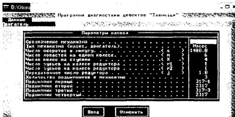
Рис. 3. Протокол ввода параметров диагностируемого механизма
