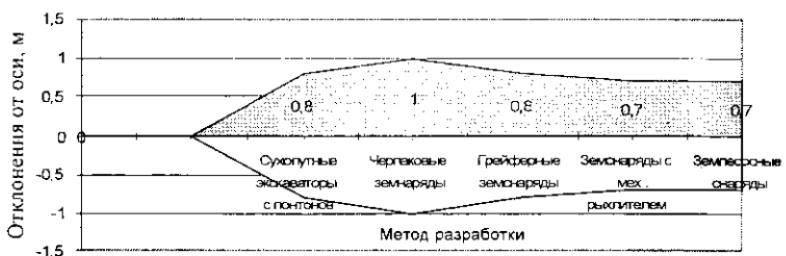
Рис. 2. Отклонения при разработке грунта  $\Delta_3$
