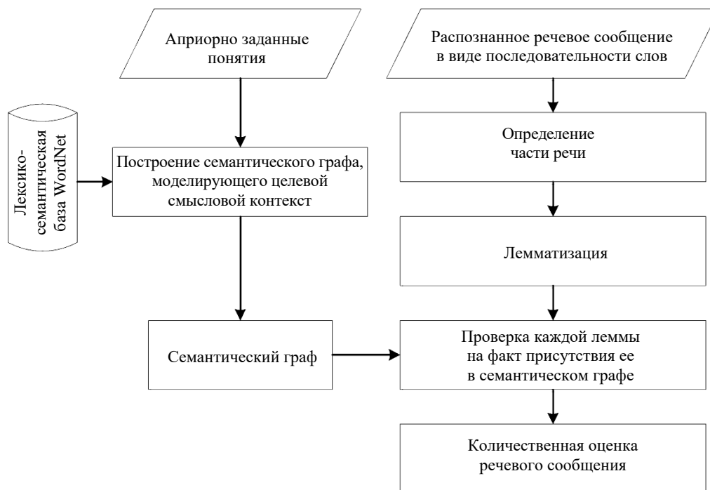
Рис. 3. Схема алгоритма семантического анализа языковой составляющей сообщения
