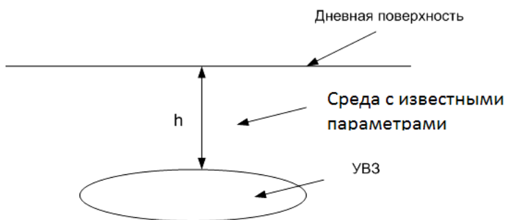
Рис. 3. Распространение радиоволн в среде с известными параметрами
