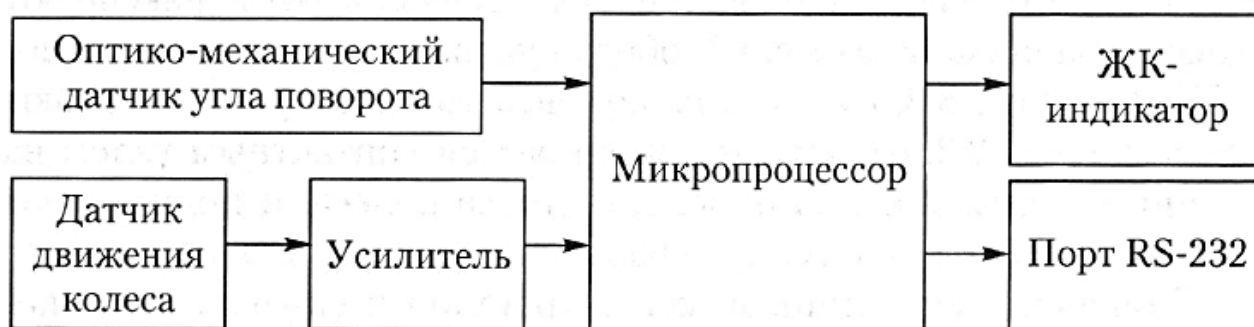
Рисунок 6.3. Функциональная схема люфтомера ИСЛ-401.
