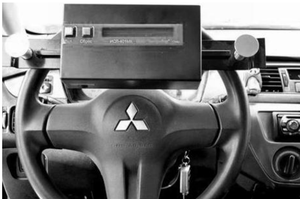
Рисунок 6.4. Установка основного блока люфтомера.
