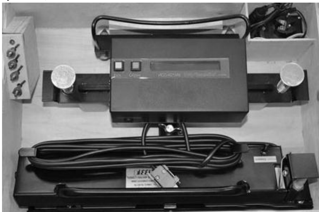
Рисунок 6.1. Люфтомер рулевого управления ИСЛ-401. Общий вид.
