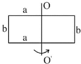
Определим  $J_a$ . Момент инерции стержня массой  $m$  и длиной  $l$  относительно оси, проходящей через центр инерции стержня перпендикулярно к нему, найдем по формуле
