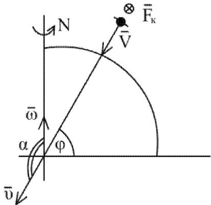
где  $\alpha$  – угол между векторами  $\vec{v}$  и  $\vec{\omega}$ . Из рисунка следует, что  $\alpha = 90^\circ + \varphi$ , откуда  $\sin\alpha = \cos\varphi$ .
