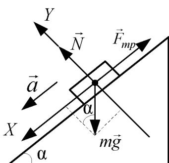
На рисунке показаны силы, действующие на тело. Согласно второго закона Ньютона для данного тела можем записать:
