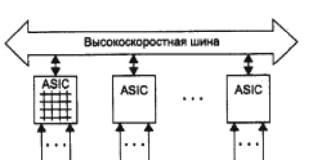
Рис. 2.80. Комбинирование архитектур коммутационной матрицы и общей шины
