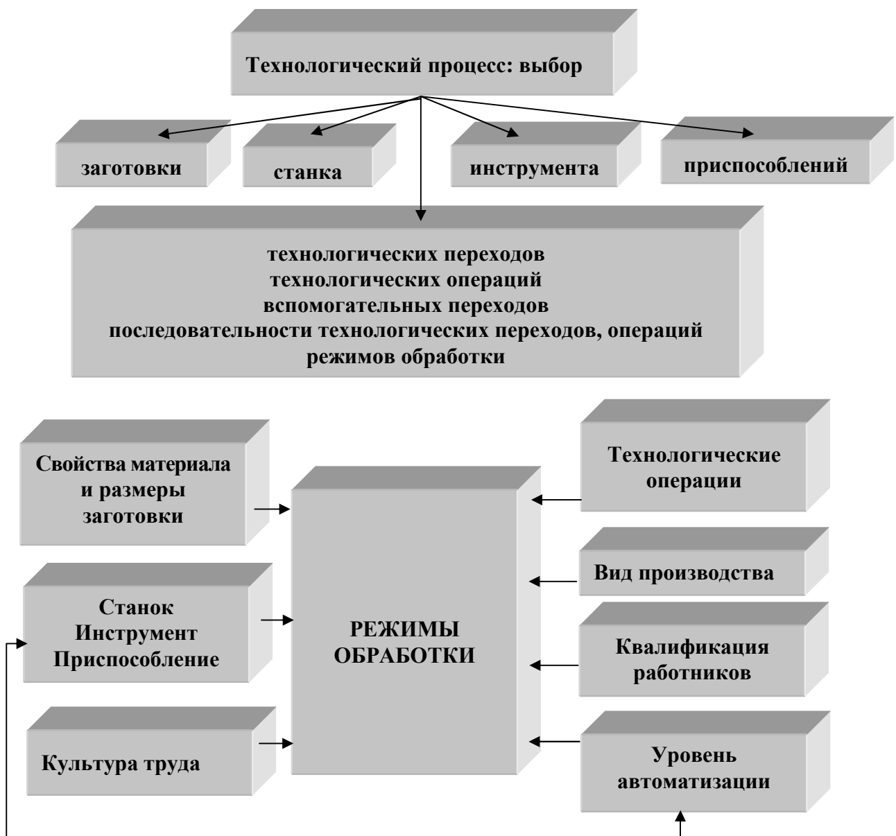
Рис. 1.1. Представление о сущности и разработке технологических процессов металлообработки в машиностроении
