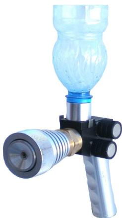
Рис. 1. Внешний вид термораспылителя
