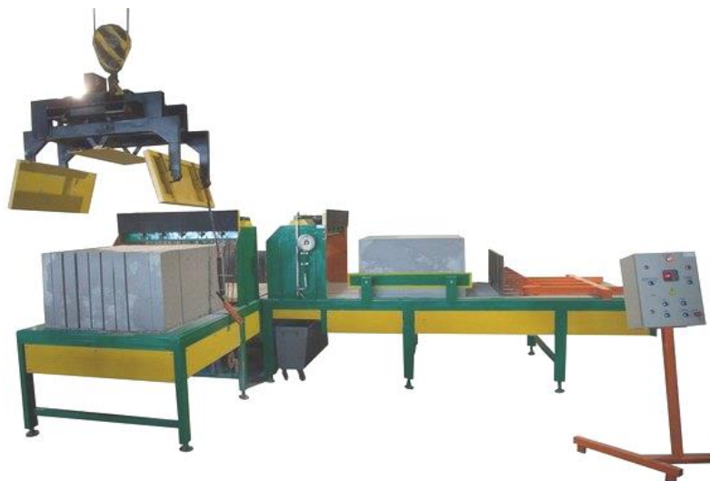
Рис. 2. Установка для резки пенобетонных массивов
