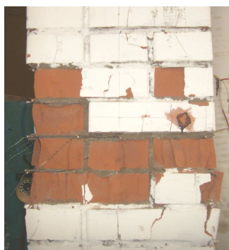
Рис. 1. Характер разрушения армированного образца
