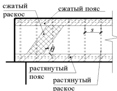
Рис. 3. Расчетная схема зоны среза изгибаемого железобетонного элемента по методу ферменной аналогии
