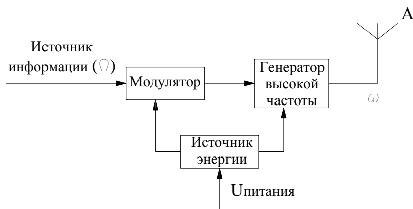
Рис. 47. Общая структура передатчика
