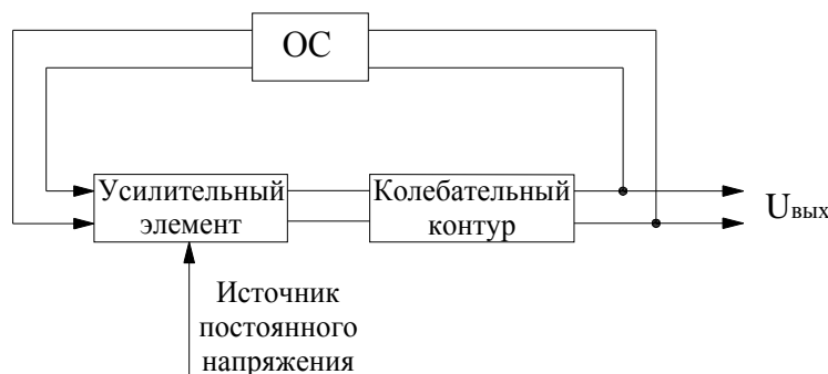
Рис. 51. Структурная схема генератора с самовозбуждением
