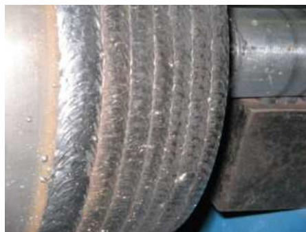
Рис. 3. Типичный фрагмент наплавленной поверхности
