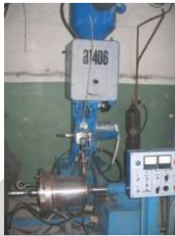
Рис. 2. Принципиальная схема и комплект оборудования для восстановления поверхностей деталей литейных пресс-форм методом дуговой наплавки
