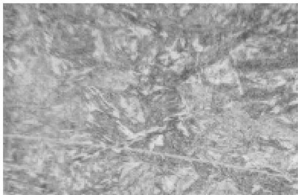
Рис. 1. Структура сварного шва, выполненного с подогревом
