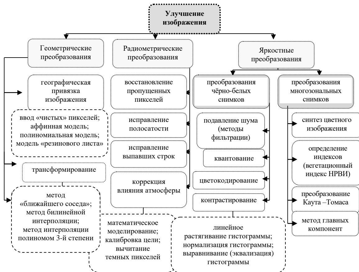
Рис. 1. Иерархическая структура методов предварительных преобразований изображений ДЗЗ
