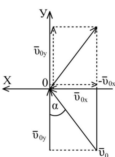
шар имел скорость  $v_0 = 5 \frac{\text{М}}{\text{с}}$ , направленную под углом  $\alpha = 30^\circ$  к поверхности.
