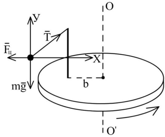
Относительно системы отсчета, связанной с вращающимся диском, шарик покоится ( $\vec{\alpha}' = 0$ ), и второй закон Ньютона с учетом центробежной силы инерции
