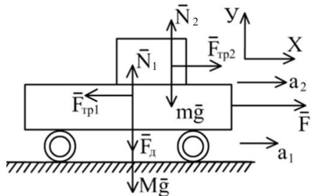
**Дано:**  $M = 20 \text{ кг}$ ;  $m = 10 \text{ кг}$ ;  $\mu = 0,1$ ;  $F_1 = 20 \text{ Н}$ ;  $F_2 = 60 \text{ Н}$ .
