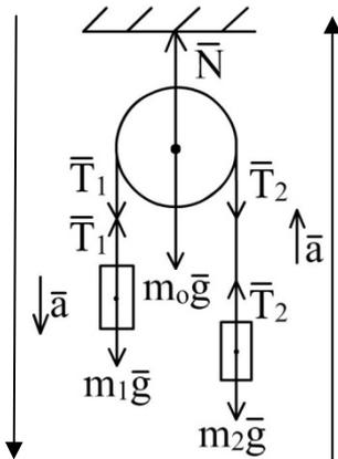
Моменты сил  $\vec{T}_1$  и  $\vec{T}_2$  направлены по оси вращения, но в противоположные стороны. Основное уравнение динамики для вращательного движения блока:
