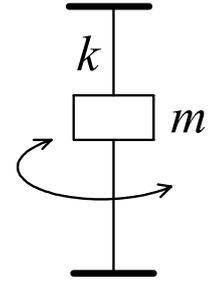
где  $J$  – момент инерции тела относительно оси, совпадающей с упругой нитью;  $k$  – жесткость упругой нити, равная отношению упругого момента, возникающего при закручивании нити, к углу, на который нить закручивается.
