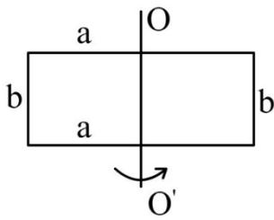
Определим  $J_b$ . Момент инерции стержня относительно оси, совпадающей с осью стержня, равен нулю. Согласно теореме Штейнера момент инерции стержня длиной  $l$  и массой  $m$  относительно оси, параллельной стержню и расположенной на расстоянии  $r$  от стержня,
