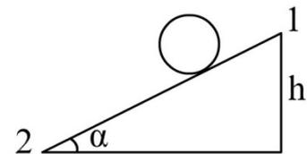
Шарик проходит путь  $S = \frac{h}{\sin \alpha}$  с ускорением  $a$ ;  $S = \frac{at^2}{2}$ , скорость в конце движения связана с ускорением:  $v = at$ ;
