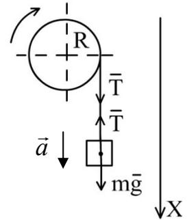
Направив ось  $X$  вертикально вниз (см. рисунок), запишем уравнение движения (второй закон Ньютона) на эту ось:
