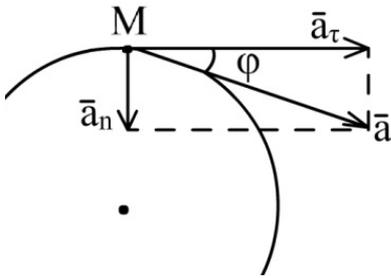
Тангенциальное ускорение  $\vec{a}_\tau$  направлено по касательной к окружности, а нормальное ускорение  $\vec{a}_n$  – перпендикулярно к  $\vec{a}_\tau$  (см. рисунок).
