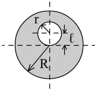
Момент инерции вырезанного диска относительно оси, проходящей через его центр инерции,
