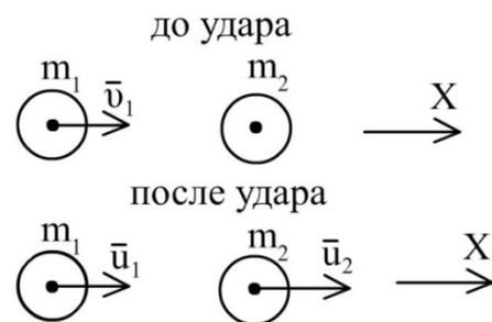
**Решение.** Запишем закон сохранения импульса в проекции на ось  $X$  (см. рисунок):
