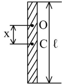
где  $J_0 = \frac{ml^2}{12}$  – момент инерции стержня относительно горизонтальной оси, проходящей через центр масс стержня (через середину стержня).
