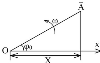
тора  $|\vec{A}|$  является амплитудой, угловая скорость вращения  $\omega$  – циклической частотой, а угол  $\varphi_0$  – начальной фазой колебаний. Метод векторной диаграммы используется при сложении гармонических колебаний одинаковой частоты и определении сдвига фаз между током и напряжением в цепях переменного тока.
