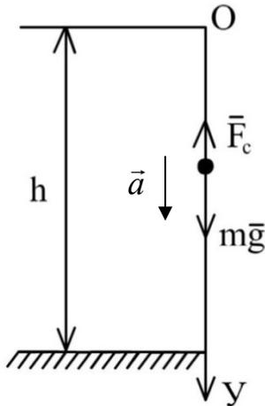
**Решение.** Рассмотрим движение в системе отсчета, связанной с Землей. Начало координат совместим с точкой, из которой начинается движение (точка  $O$  на рисунке), ось  $OY$  направим по вертикали к Земле. Считая высоту  $h$  малой по сравнению с радиусом Земли, примем ускорение свободного падения  $g = 9,8 \frac{\text{м}}{\text{с}^2}$ . На парашютиста действуют две силы: сила тяжести  $m\vec{g}$  и сила сопротивления воздуха  $\vec{F}_c = -r\vec{v}$ .
