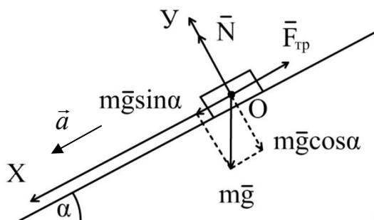
Тело движется вниз равноускоренно по наклонной плоскости, и зависимость пройденного пути от времени задается уравнением  $S = 2t + 1,6t^2$ .
