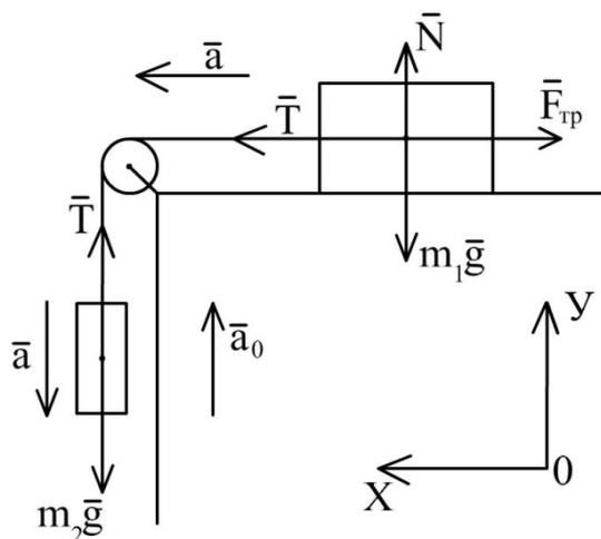
натяжения нити, если коэффициент трения между грузом  $m_1$  и опорой  $\mu = 0,1$  и ускорение груза  $m_2$  относительно неподвижной системы отсчета.
