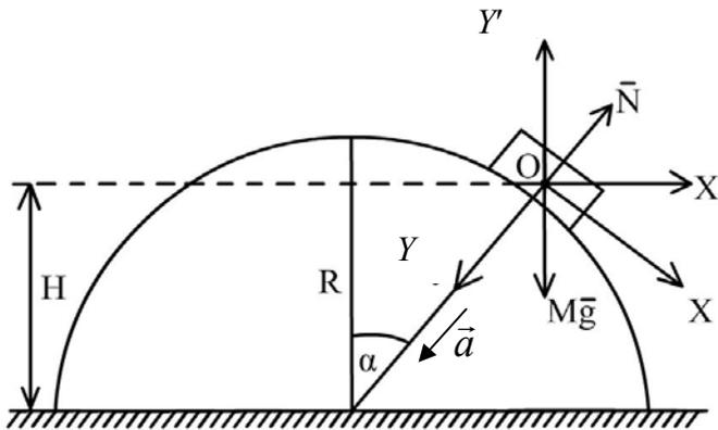
**Решение.** На тело действует сила тяжести  $M\vec{g}$  и сила реакции опоры  $\vec{N}$ . Уравнение движения имеет вид
