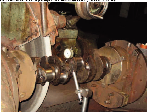
Рис. 1. Измерение смещения оси обрабатываемой шейки коленчатого вала от оси вращения шпинделя станка
