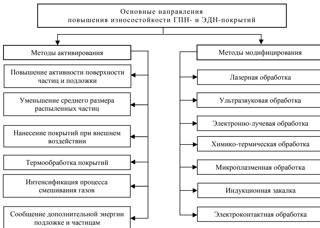
Рисунок 3 – Основные направления повышения износостойкости ГПН- и ЭДН-покрытий
