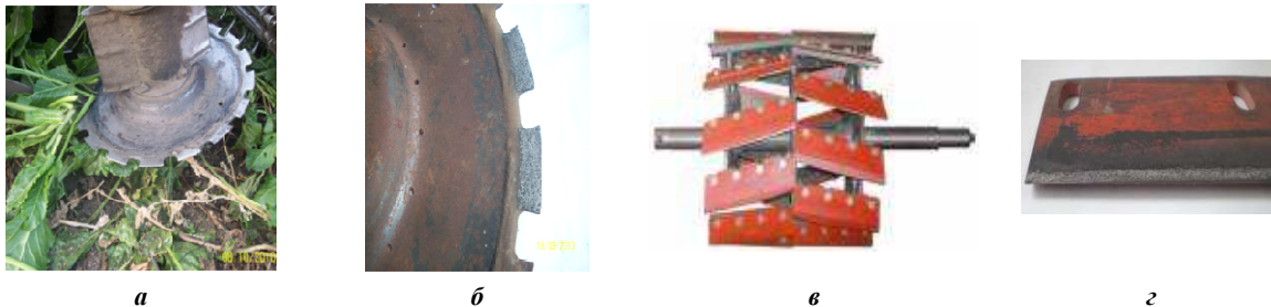
Рисунок 6 – Ножи с покрытиями свеклоуборочных машин (а, б) и измельчительного барабана (в, г) комбайна
