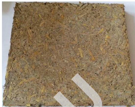
Рис. 2. Плита на основе смеси соломы с кострой льна
