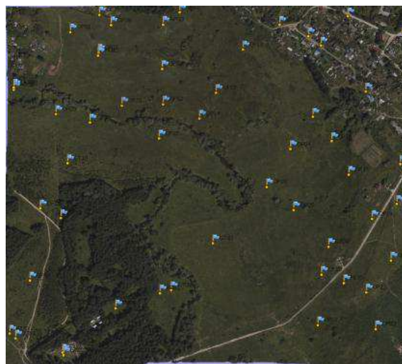
Рис. 14. Участок полигона №4 площадью 1 км 2 с маркированными опознаками для калибровки цифровых камер
