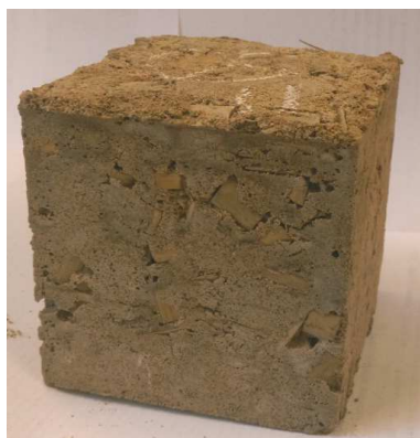
Рис. 1. Внешний вид образца арболита на основе бамбука и опилок
