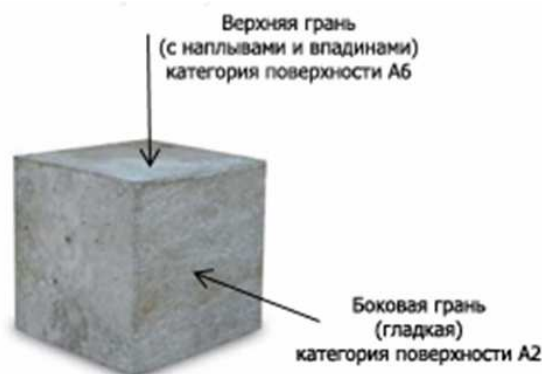
Рис. 1. Образец для испытания (кубик 100х100)
