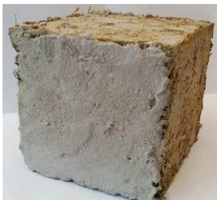
Рис. Поверхность арболита, оштукатуренная цементно-известковым раствором марки 50
