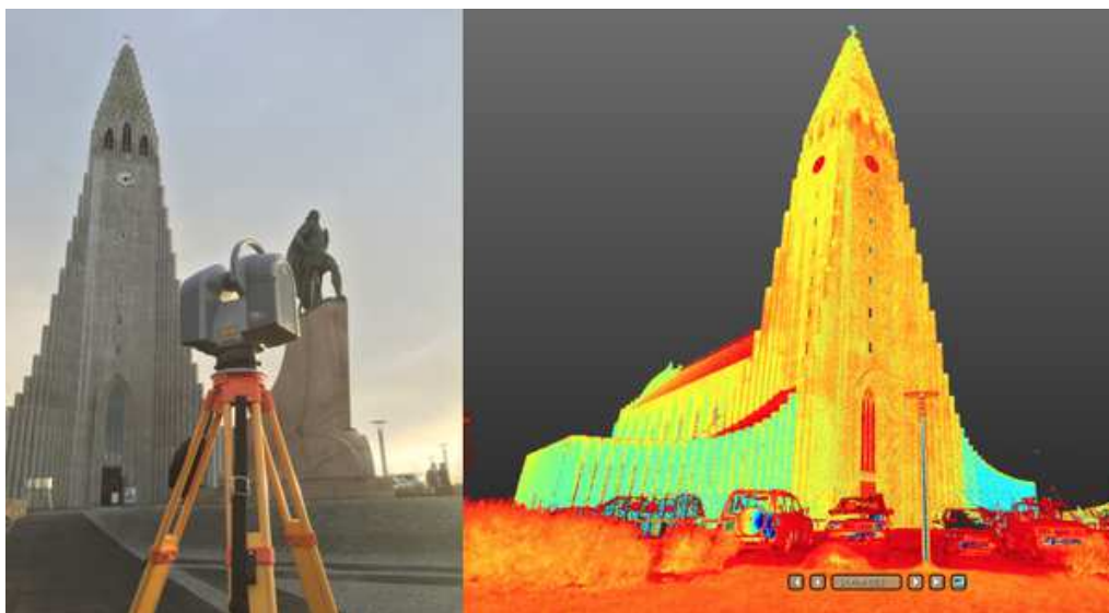
Рис. 2. Результат наземного лазерного сканирования
