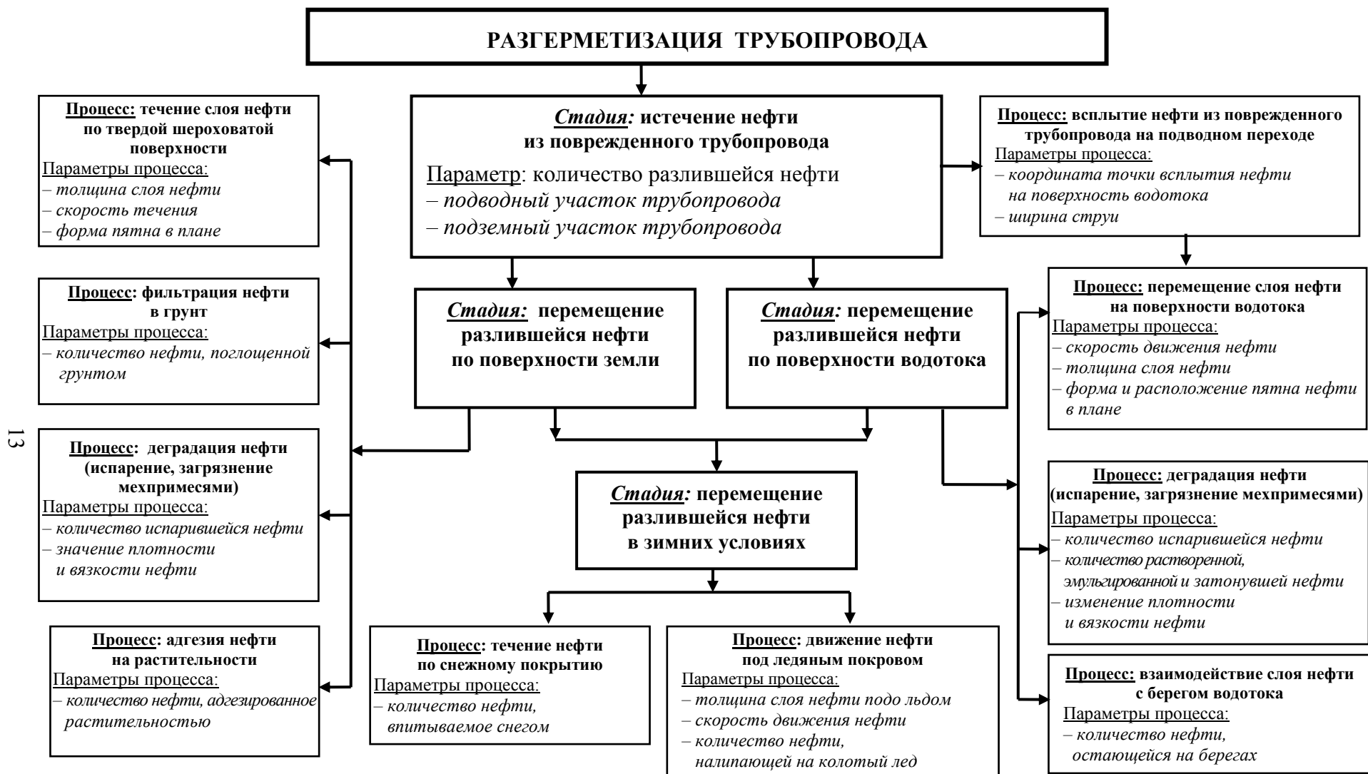
Рисунок 3 – Схема механизмов развития аварии по стадиям и ее состав по физическим процессам
