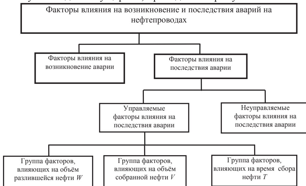
Рисунок 2.3 – Структура факторов влияния на последствия АРН на МНП
