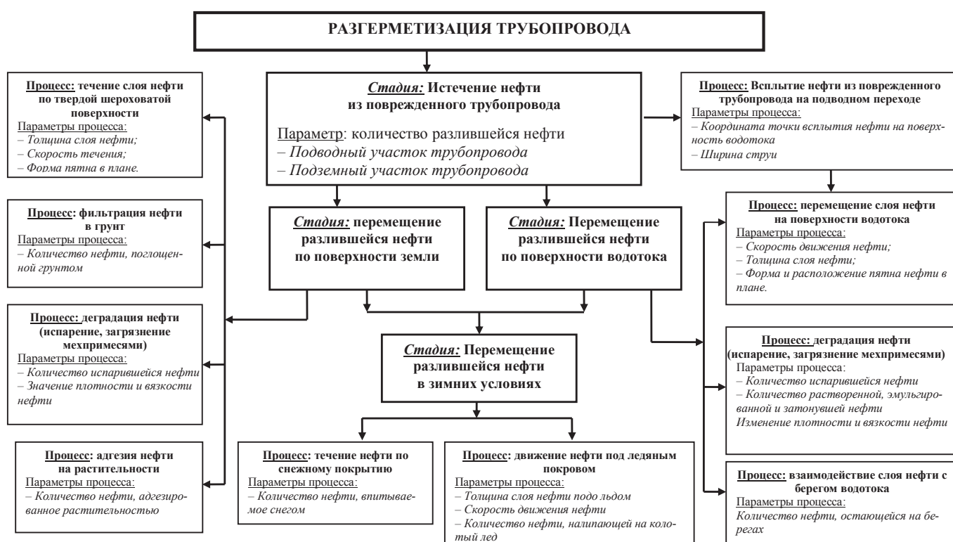
Рисунок 2.2 – Схема механизмов развития аварии по стадиям и ее состав по физическим процессам
