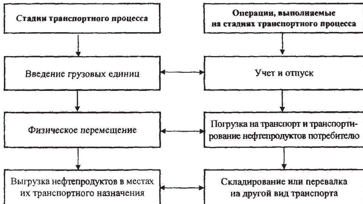
Рисунок 3.5 – Транспортный процесс светлых нефтепродуктов
