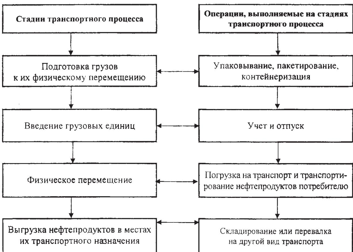
Рисунок 3.8 – Транспортный процесс твердых высокозастывающих нефтепродуктов
