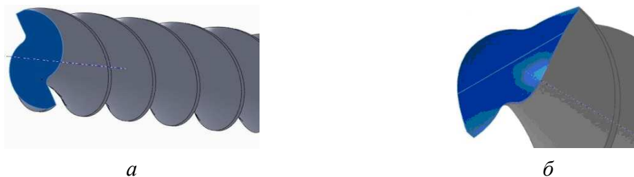
Рис. 1. Поперечное (а) и минимальное (б) сечения шнекового сверла
