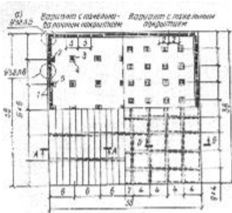
Рис. XVI.10. Прямоугольный сборный резервуар а - план; б - разрез при варианте с панельно-балочным покрытием; в - то же, панельным покрытием; 1 - стеновые панели; 2 - крайняя колонна; 3 - фундаментный блок; 4 - промежуточная колонна; 5 - фундамент крайней колонны (претип в дашке); 6 - конольное днище; 7 - балка покрытия; 8 - плита
