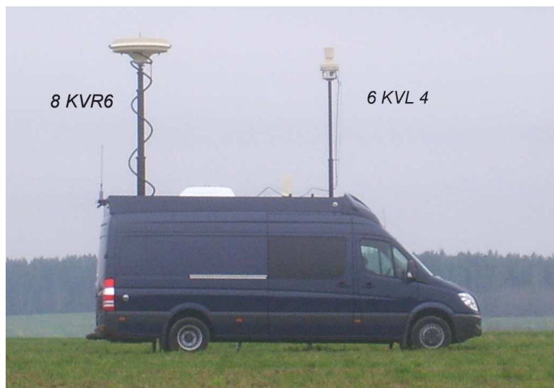
Рис. 1 – ПАК «Аргус» с поднятыми телескопическими мачтами
