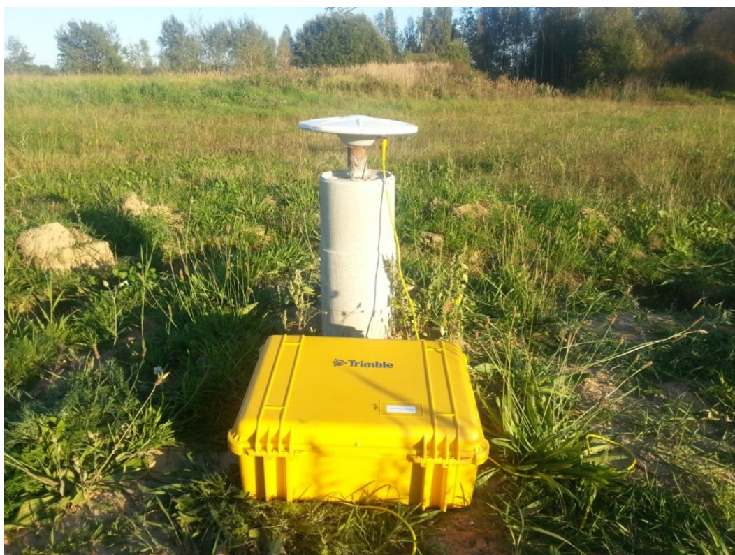
Рисунок 8 – Вид центра с приспособлением для принудительного центрирования спутниковых антенн на местности.
