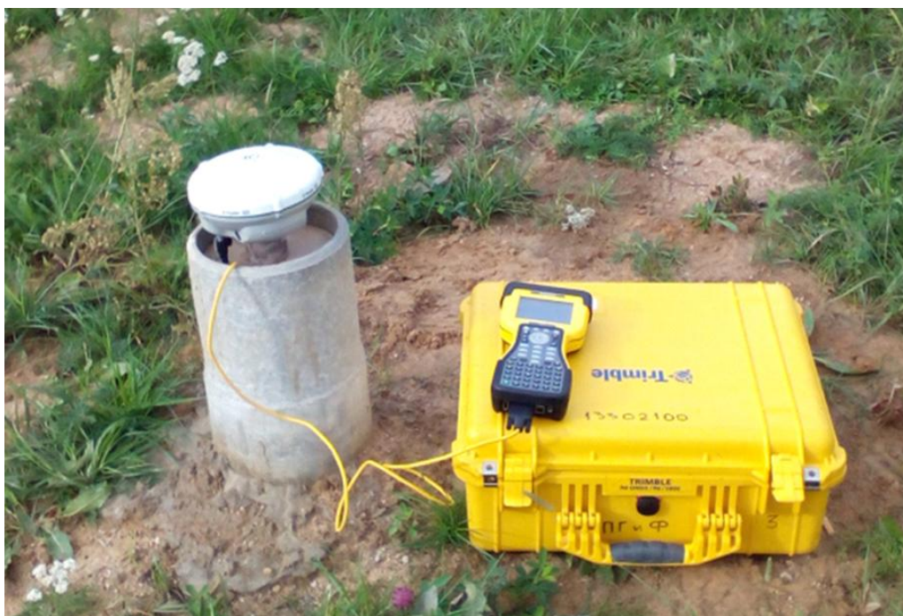
Рисунок 13 –Выполнение ГНСС наблюдений на пункте MINT (Минтурово) ГДП «Полоцкая ГЭС» в 2017 г.
