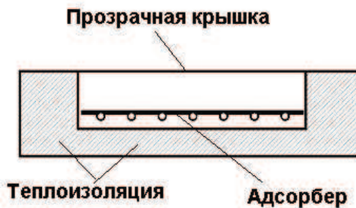
Рисунок 1.7 – Схема и вид плоскостной солнечного коллектора
