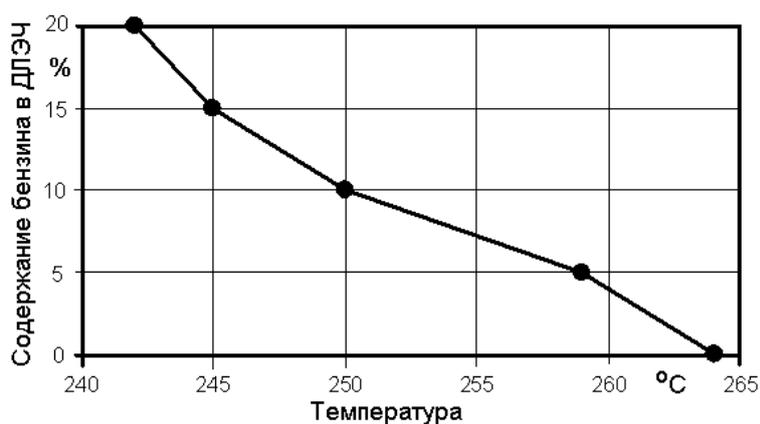
Рис. 2. Температура выкипания 50 % топлива
