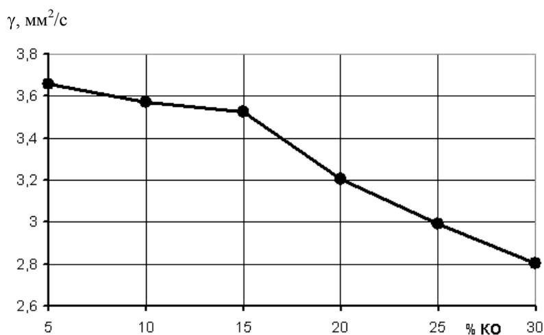
Рис. 4. График вязкости смеси дизельного топлива с керосином
