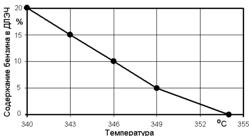
Рис. 3. Температура выкипания 96 % топлива
