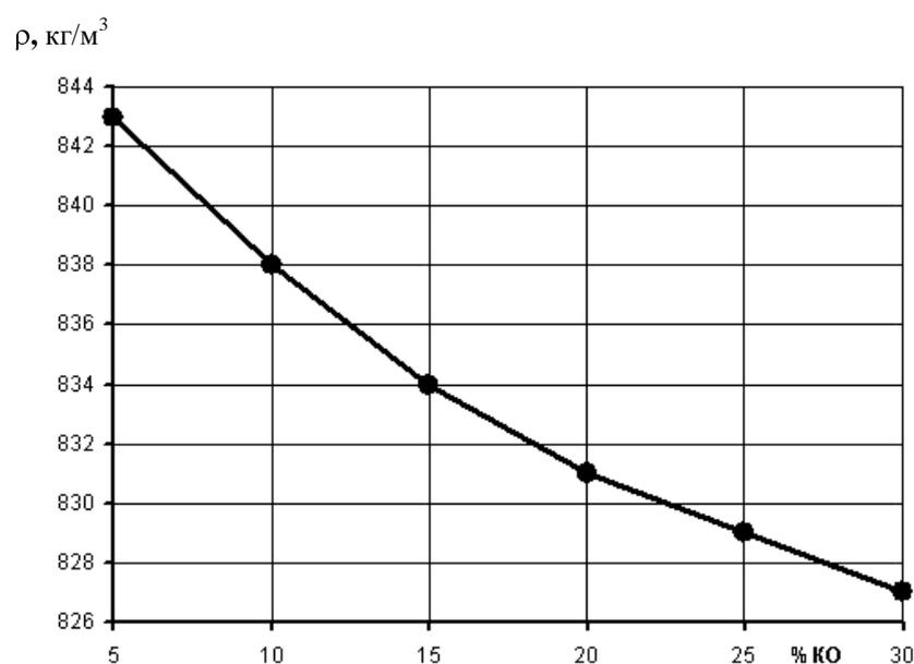
Рис. 5. График плотности смеси дизельного топлива с керосином
