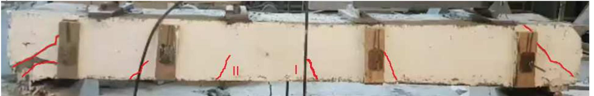
Рис. 2.17 Схема трещинообразования Плиты II а) до начала нагружения б) после испытания
