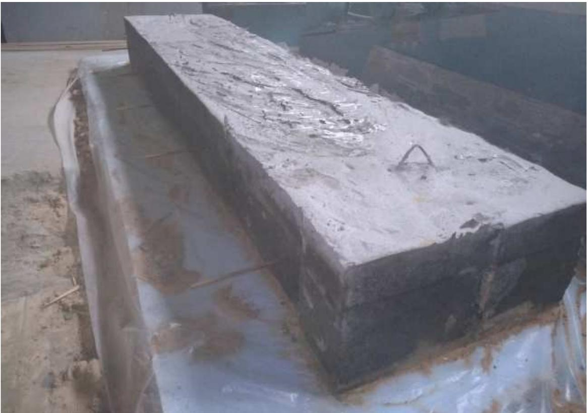
Рис. 2.6 Образец плиты после разборки опалубки
