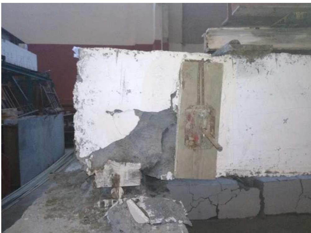
Рис. 2.11 Разрушение плиты II на опоре а) с торца б) вид у опоры
