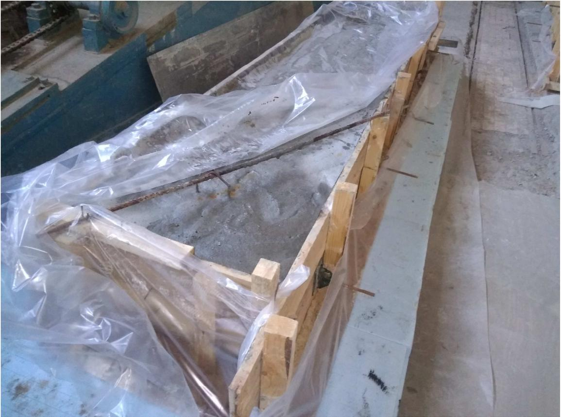
Рис. 2.5 Образец плиты в опалубке
