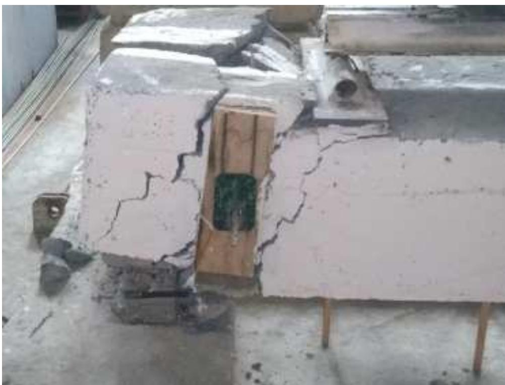
Рис. 2.10 Разрушение плиты I на опоре а) с торца б) вид у опоры
