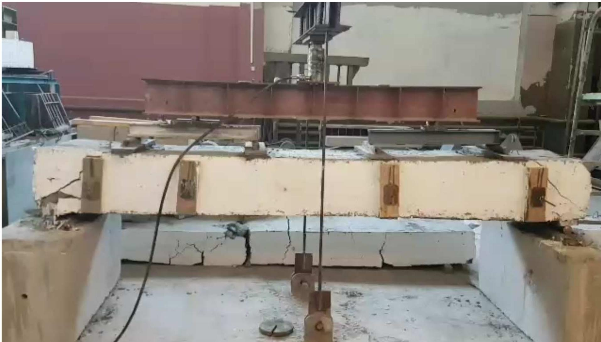
Рис. 2.15 Плита II после испытания
