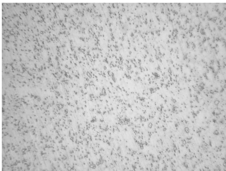
**Рисунок 5.2 – Микроструктура стали 15X5M (×500, репродукция ×3)**
