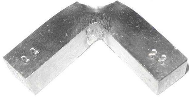
**Рисунок 2.6 – Фотография образца после испытания на ударный изгиб по ГОСТ 9454, на котором измерялась твердость по Виккерсу**
