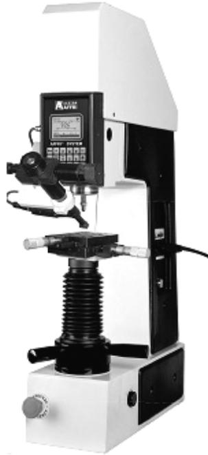
**Рисунок 2.4 – Твердомер AFFRI 251 VRSD, использованный для измерения твердости по Виккерсу в стационарных условиях**
