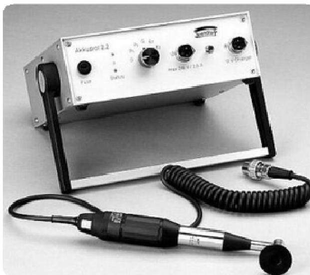
**Рисунок 2.10 – Переносной шлифовально-полировальный станок «Аккурол 2.2», использованный для подготовки поверхности**
