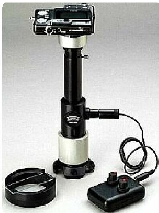
**Рисунок 2.12 – Переносной металлографический микроскоп ТКМ**
