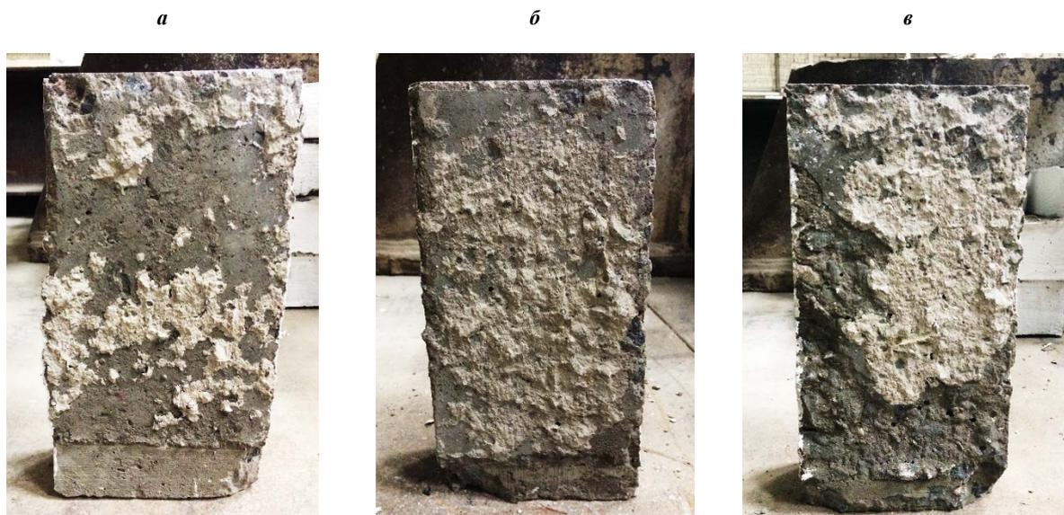
Рисунок 2. – Общий вид поверхностей нового бетона после разрушения: а – образец 0,4%; б – образец 0,7%; в – образец 1,0%
