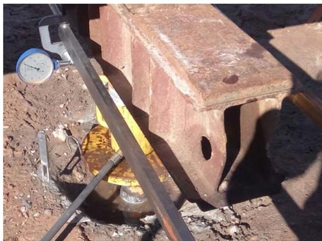
Рисунок 1. – Общий вид установки для испытания свай методом релаксации напряжений (вид сверху)
