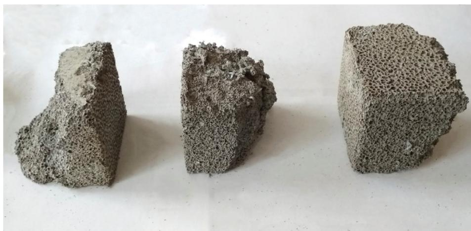
**Рисунок 1. – Образцы пенобетона, армированные отходами стеклосетки после испытаний прочности на сжатие:**
