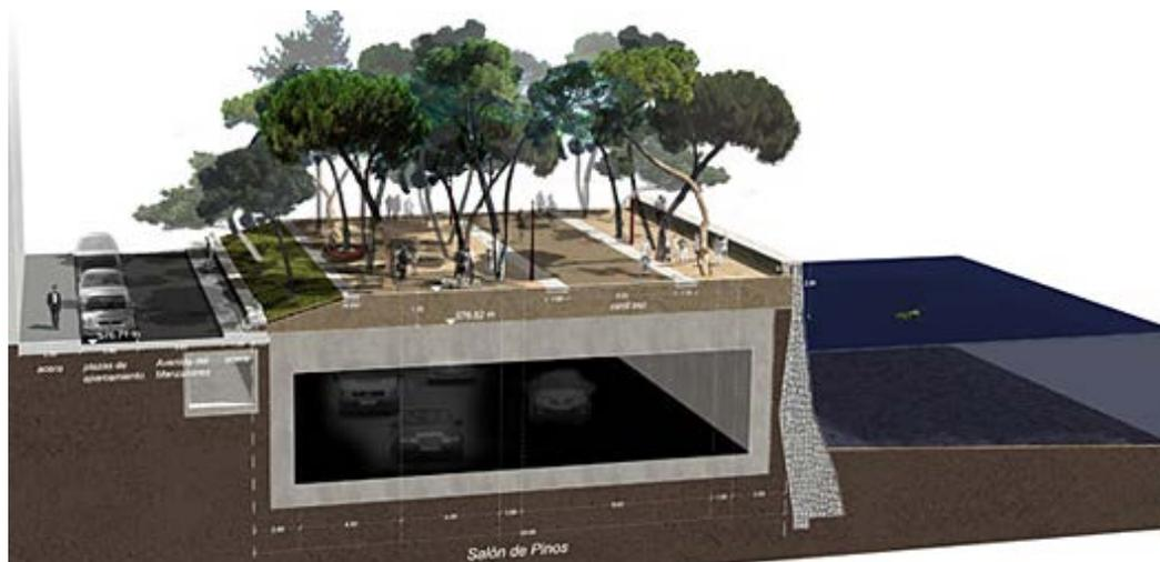
**Рисунок 2. – Второй вариант преобразования набережной путем заглибления проезжей части, г. Мадрид, Испания**
