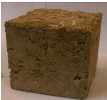
Рисунок 1. – Внешний вид образца стенового материала на основе бамбука и опилок
