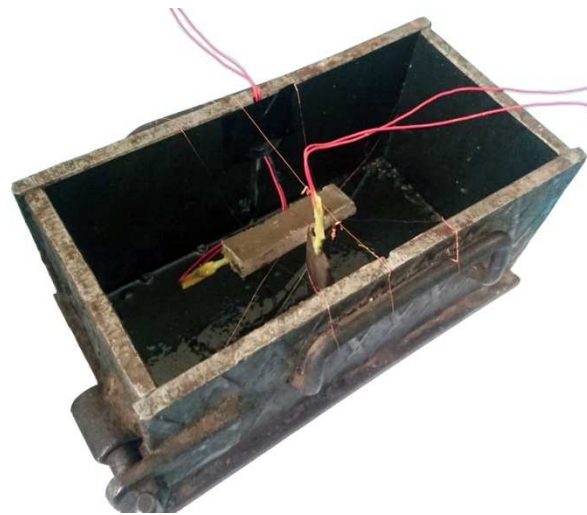
Рисунок 2. – Схема расположения глубинных датчиков в опалубке
