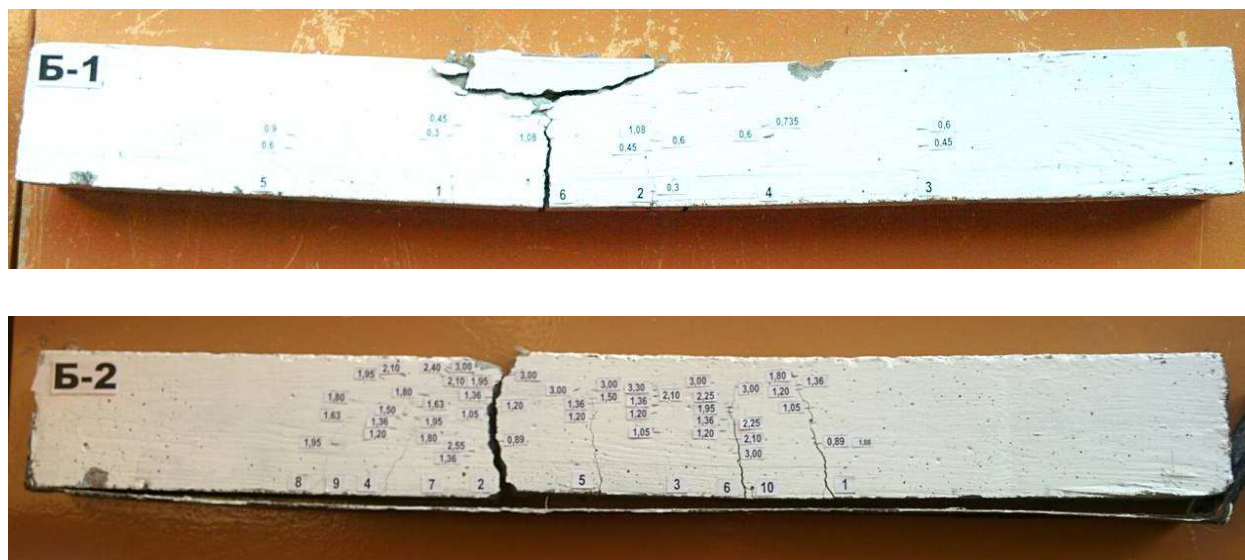
Рисунок 2. – Характер разрушения экспериментальных балок
