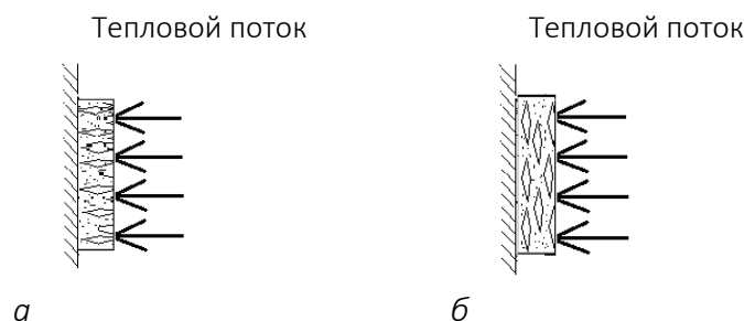
Рисунок 1. – Схема прохождения теплового потока при определении теплопроводности арболита, полученного по технологии колебательного уплотнения: а – горизонтальное расположение щепы; б – вертикальное расположение щепы
