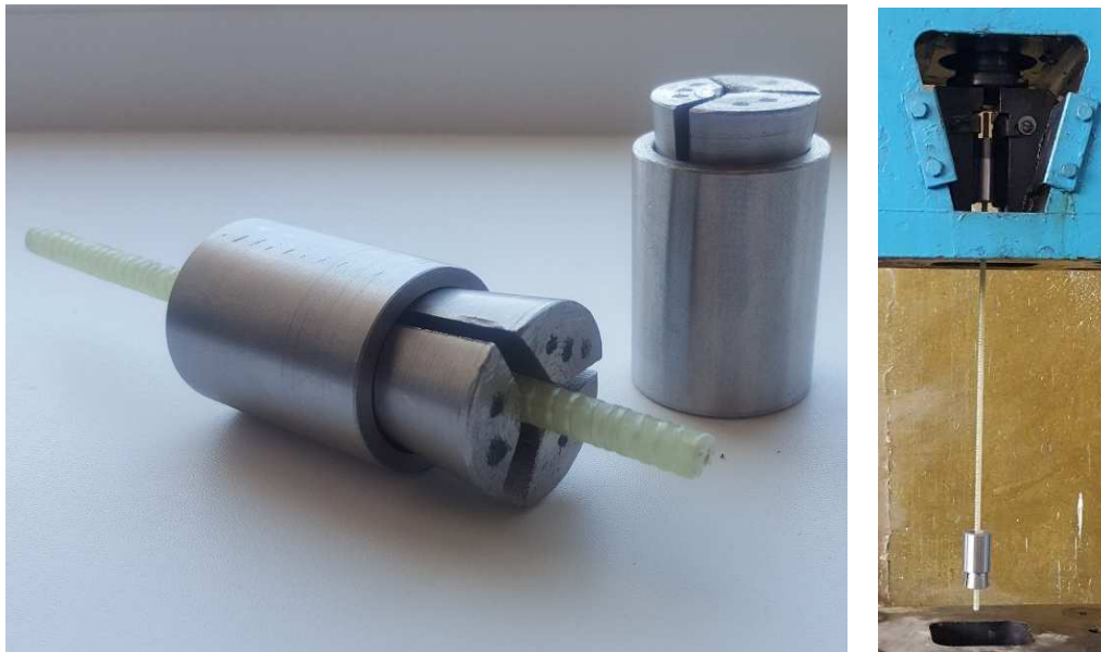
Рисунок 3. – Прототип концевго зажима для испытания и получения предварительного напряженной композитной арматуры периодического профиля
