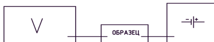
Рисунок 3. – Оборудование, использованное для тарирования датчиков: 1 – вольтметр; 2 – бетонный образец с установленными глубинными датчиками; 3 – источник питания постоянного тока
