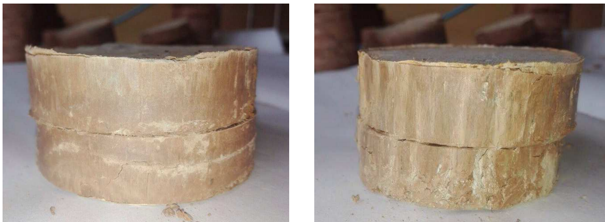
Рисунок 1. – Образцы ленточной глины после испытания на срез
