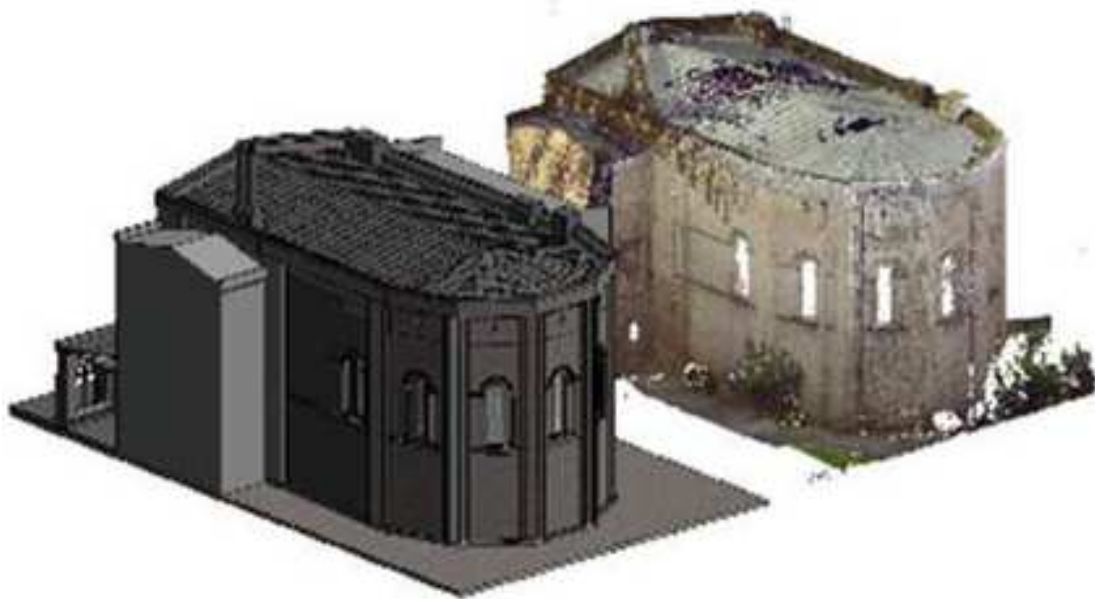
Рисунок 2. – 3D-модель, созданная на основе облака точек
