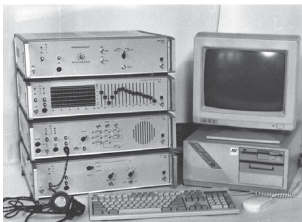
Комплекс серии ПАКОРС, применяемый для шумочистки фонограмм (1980-е гг.)
