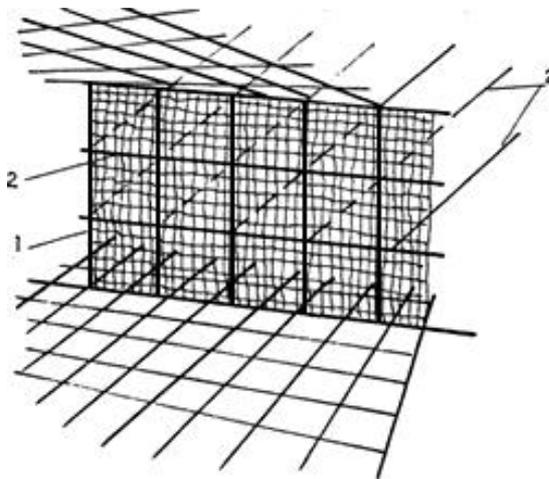
Рисунок 1. – Внутренняя опалубка рабочего шва плиты:
