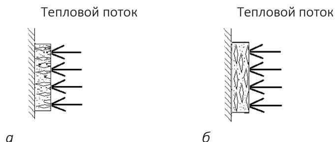
Рисунок 1. – Схема прохождения теплового потока при определении теплопроводности арболита, полученного по технологии колебательного уплотнения:
