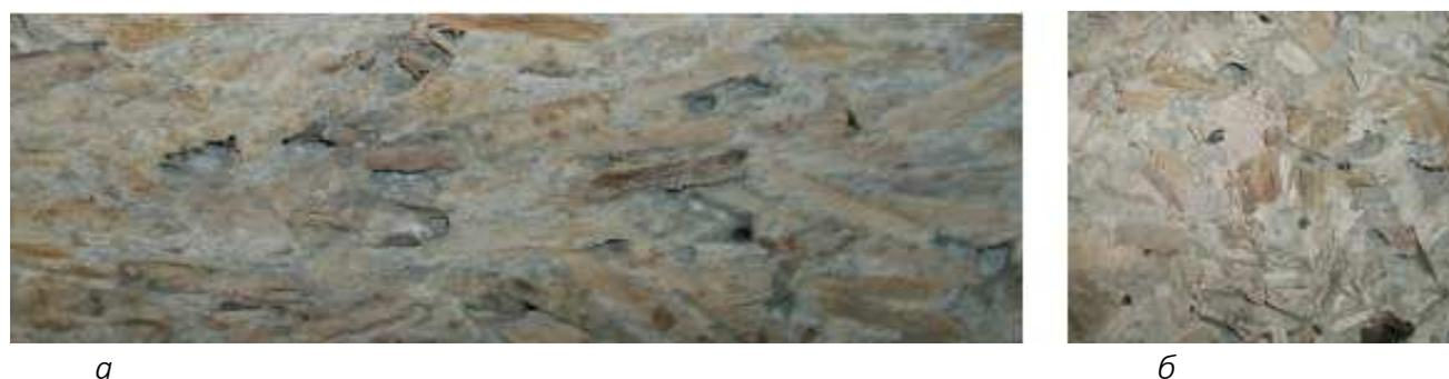
Рисунок 2. - Арболитовый блок в разрезе:
