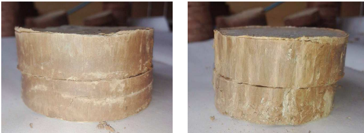
Рисунок 1. – Образцы ленточной глины после испытания на срез
