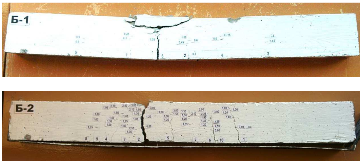
Рисунок 2. – Характер разрушения экспериментальных балок
