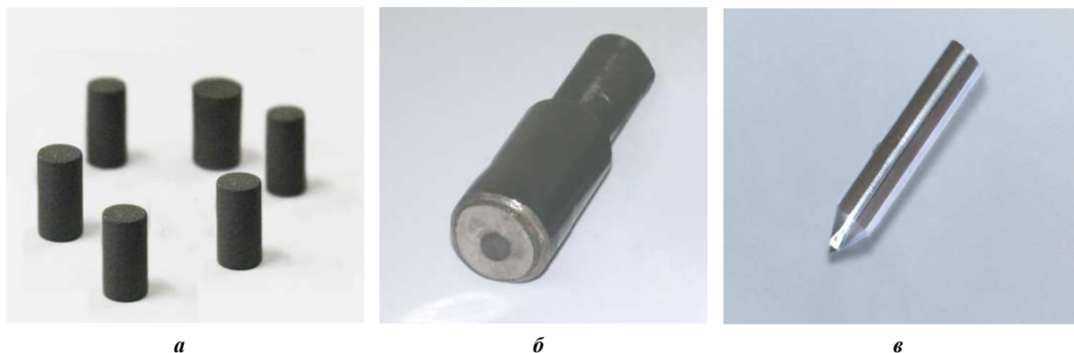
Рисунок 7. – Поликристаллические блоки (а) и правящий инструмент (б – карандаш; в – игла), изготовленные на основе ПКСТМ из модифицированных микро- и нанопорошков алмаза
