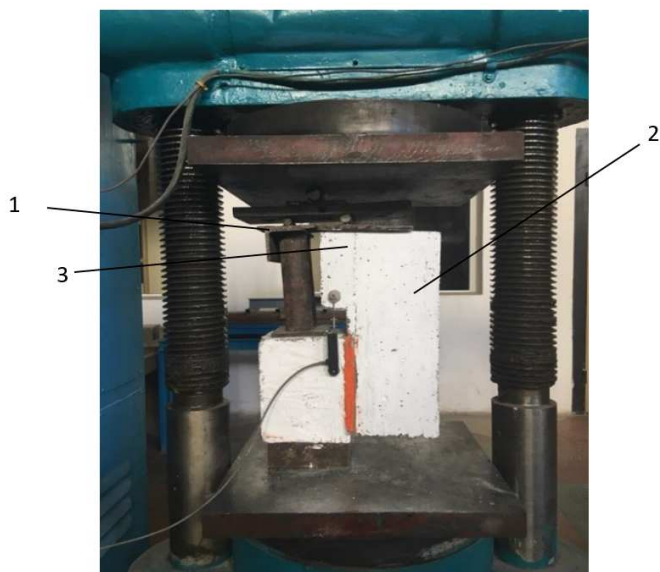
1 – сборный (старый) бетон; 2 – бетон намоноличивания; 3 – композиция
