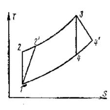
Теоретический цикл газотурбинной установки с подводом теплоты при p= const на Тs-диаграмме изображается пл. 12341, а реальный цикл пл. 12'34'1, где линия 1-2' представляет собой условную необратимую ( $\Delta s>0$ ) адиабату сжатия в компрессоре, а линия 3-4' — условную необратимую ( $\Delta s>0$ ) адиабату расширения в турбине.
