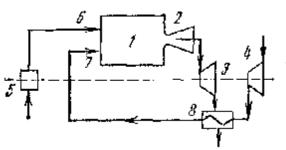
Сжатый воздух из турбокомпрессора направляется в регенератор 8, где получае теплоту при постоянном давлении от газов, вышедших из камеры сгорания 1 через сопло 2 в турбину 3. Подогретый воздух из регенератора 8 через форсунку 7, а топливо
