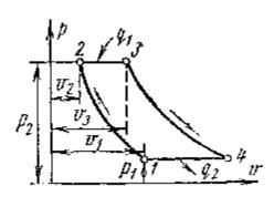
В идеальном цикле ГТУ отвод теплоты от рабочего тела производится не по изохоре, как это имеет место в двигателях внутреннего сгорания, а по изобаре.
