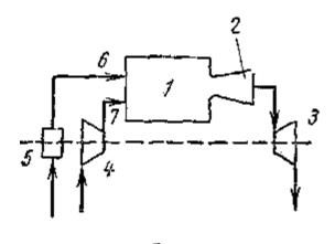
В камеру сгорания 1 через форсунки 6 и 7 непрерывно поступает воздух из турбокомпрессора 4 и топливо из топливного насоса 5.
