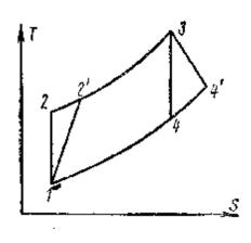
Расширение газа в турбине сопровождается потерями на трение о стенки сопл, лопаток и на завихрения потока, в результате чего часть кинетической энергии рабочего тела превращается в теплоту и энтальпия газа на выходе из турбины  $i_4$ / будет больше энтальпии обратимого процесса расширения  $i_4$ .
