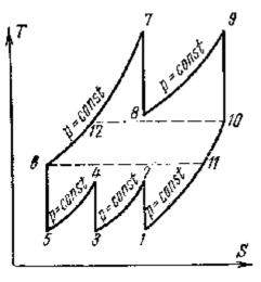
После расширения в турбине (7-8) газ поступает во вторую камеру сгорания, где вследствие сжигания топлива при постоянном давлении он опять нагревается до предельног температуры (8-9). Затем продукты сгорания расширяются во второй турбине (или во второй ступени турбины) (9-10) и выбрасываются в атмосферу.
