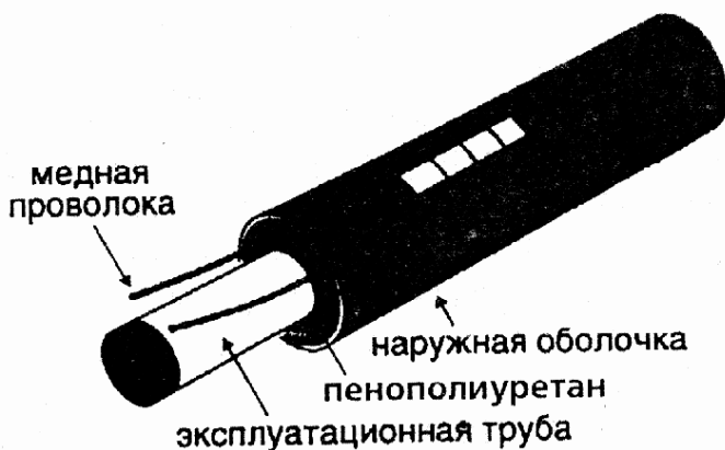
Рис. 10.4. Общий вид предварительно изолированной трубы.
