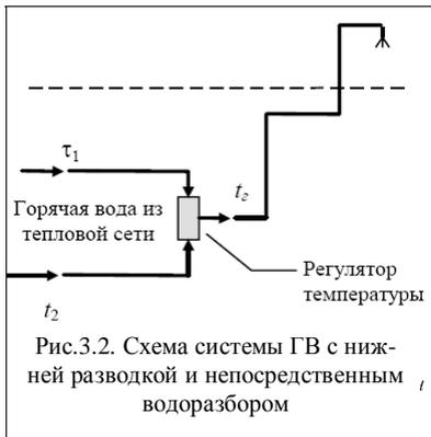
Рис.3.2. Схема системы ГВ с нижней разводкой и непосредственным водоразбором
