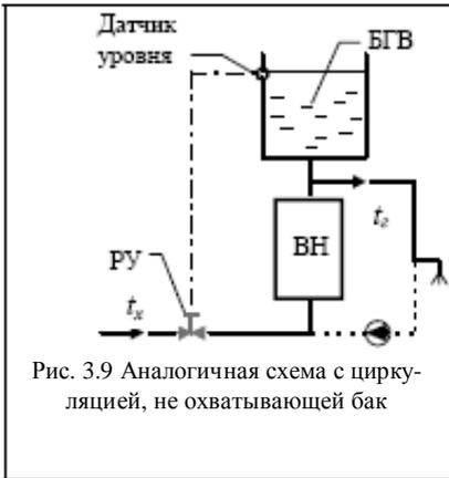
Рис. 3.9 Аналогичная схема с циркуляцией, не охватывающей бак
