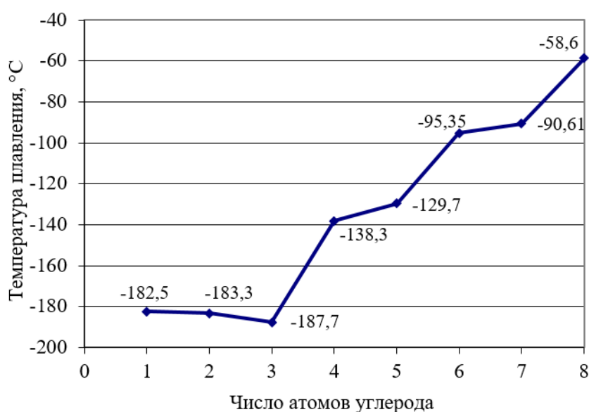
Рисунок 2.6. – Зависимость температуры плавления n -алканов от числа атомов углерода
