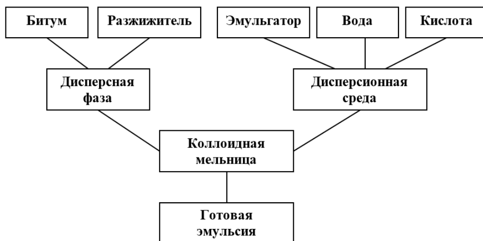
Рисунок 5.6. – Блок-схема получения катионной битумной эмульсии
