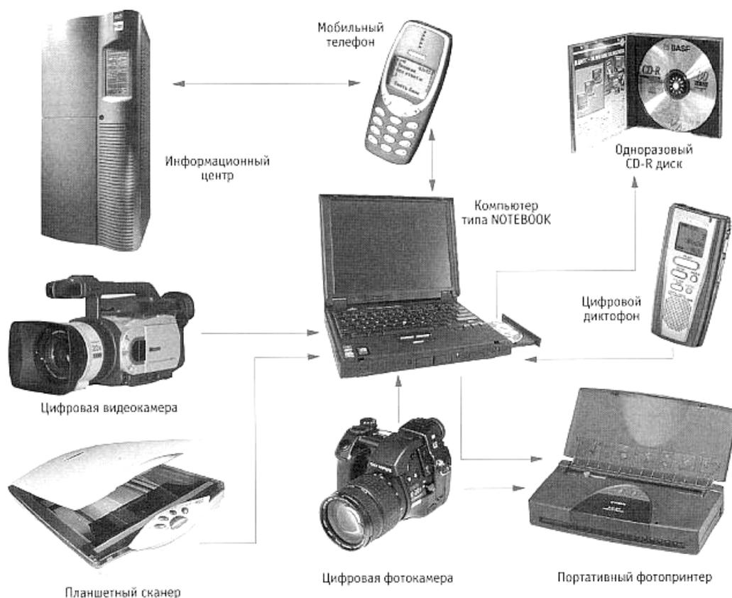
Рис. 1. Схема одной из версий мобильного комплекса технико-криминалистического обеспечения системной обработки криминалистически значимой информации (МКК СОИ)
