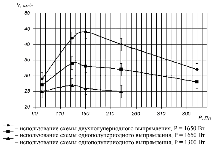
Рис. 2. Влияние величины давления O_2 в разрядной области на скорость удаления фоторезиста с поверхности кремниевых пластин для различных источников питания СВЧ-магнетрона
