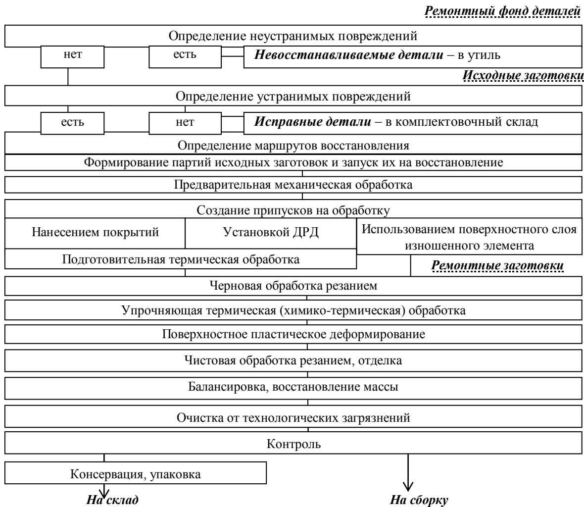
Рис. 2. Схема технологического процесса восстановления детали
