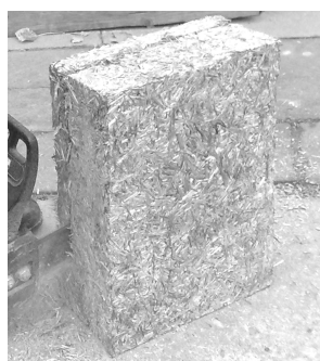
Рис. 1. Распил бензопилой плиты в продольном направлении
