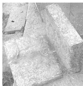
Рис. 2. Ровная поверхность по грани распила, отсутствие сколов на углах и ребрах
