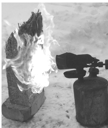
Рис. 3. Воздействие огня на плиту в процессе испытания
