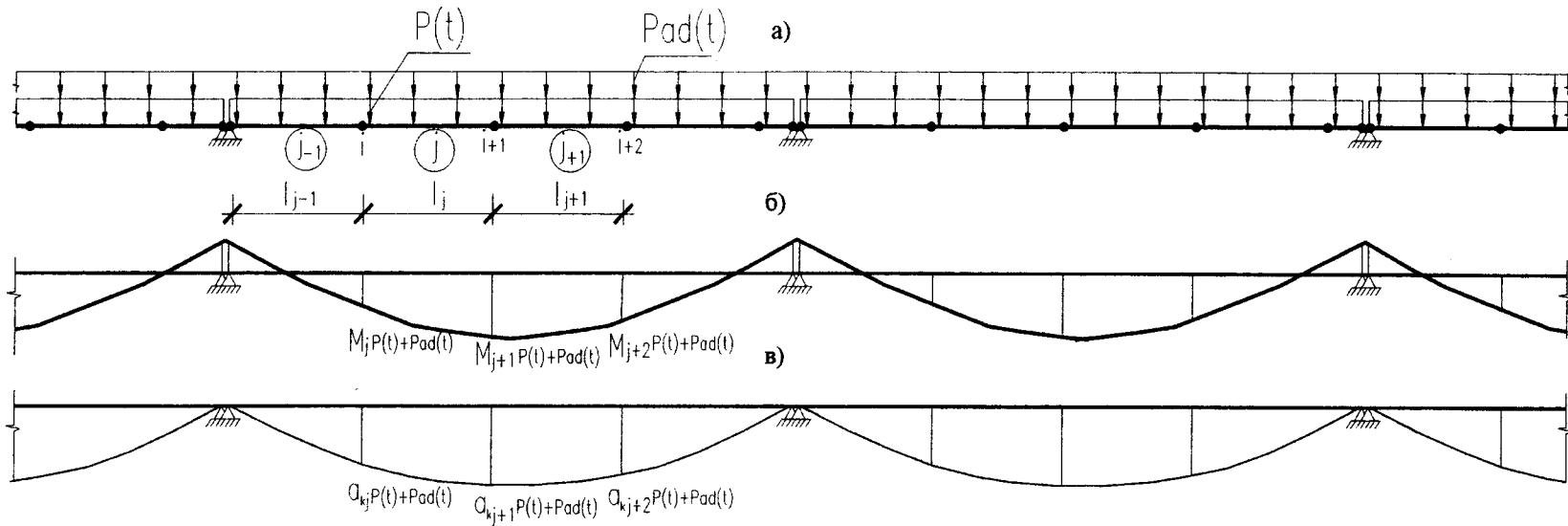
Рис. 2. Расчетная схема усиленной конструкции (а), эпюра изгибающих моментов (б), эпюра перемещений (в)
