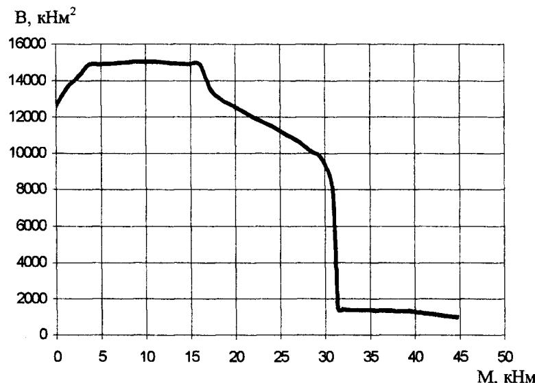
Рис. 3. Зависимость «изгибающий момент – изгибная жесткость» для изгибающего предварительно напряженного железобетонного элемента
