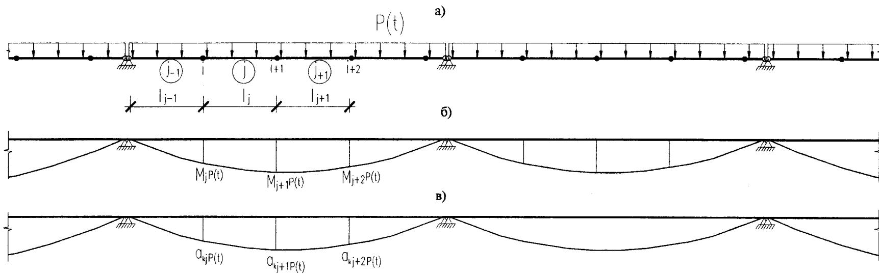
Рис. 1. Расчетная схема конструкции до усиления (а), эпюра изгибающих моментов (б), эпюра перемещений (в)
