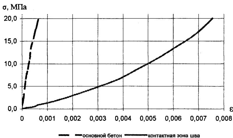
Рис. 7. Зависимость « $\sigma - \varepsilon$ » для основного бетона и контактной зоны шва
