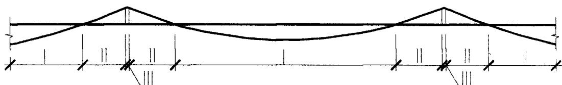
Рис. 8. Схема характерных участков при определении жесткостных характеристик сечений усиленной конструкции
