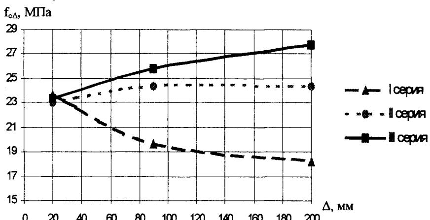
Рис. 5. Зависимость прочности опытных образцов от величины шва
