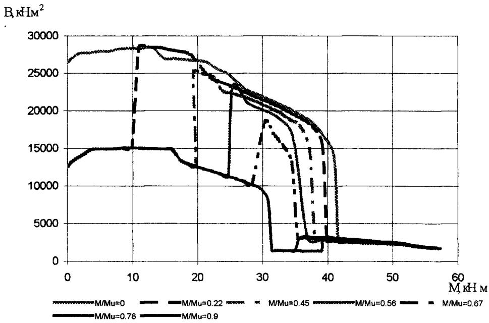
Рис. 9. Зависимость «изгибающий момент – изгибная жесткость» для изгибаемого железобетонного элемента, усиленного наращиванием в сжатой зоне:
